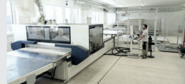
Optimaler Materialfluss auf kleinem Raum: Der Schreinertraum wird vollautomatisch vom Plattenlager (hinten) mit fertig etikettierten Platten beschickt. Ist die Bearbeitung abgeschlossen, fahren die fertigen Einzelteile über das Auslaufband (L) aus der Maschine heraus und sind fertig für die weitere Bearbeitung.
