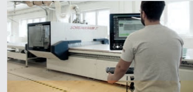
Herzstück der Produktion ist ein „Schreinertraum“. Dahinter verbirgt sich das CNC-Bearbeitungszentrum Morbidelli N100 von SCM.
