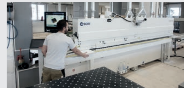
Die SCM-Kantenleimmaschine Stefani KD ist mit automatischer Teilerückführung und -abstapelung ausgestattet. Die Maschine hat Schmelzklebe- und auch Heißlufttechnologie für Laserkanten an Bord.
